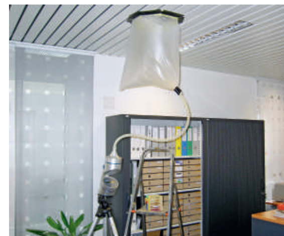
Messung der Zuluft im Büro: Seit 2009 können auch bestehende Gebäude zertifiziert werden.
